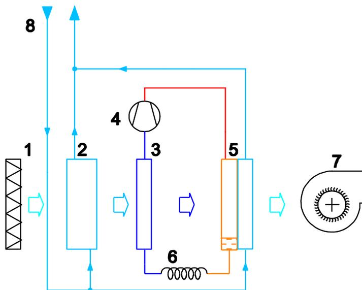
Fig. 1 Schema del deumidificatore DCS26 L
